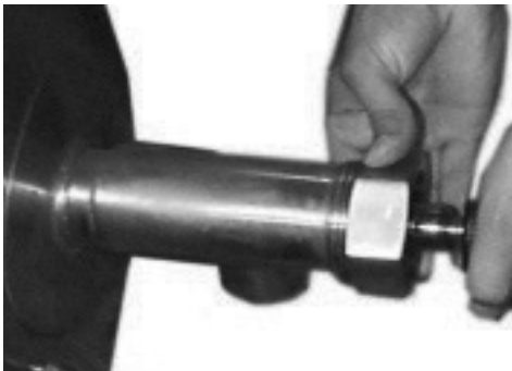
Lors de la fixation du vidange de la soupape, serrer l'écrou à la main
